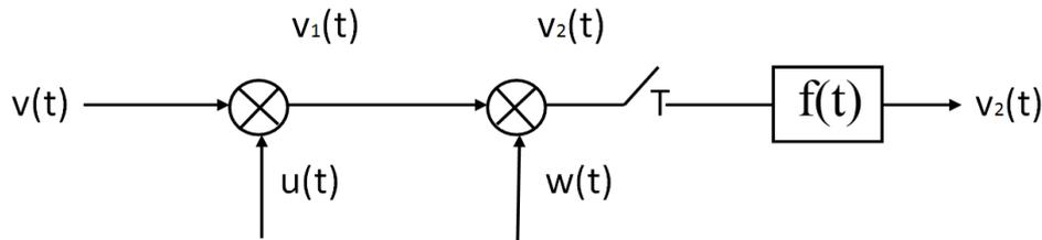
dove  $u(t) = e^{-j10\Pi t}$ ,  $w(t) = \cos(4\Pi t)$  e  $f(t)$  e' il filtro passa basso ideale centrato in origine di ampiezza unitaria e risposta in frequenza  $F(f) = \Pi\left(\frac{f}{2f_L}\right)$ .
