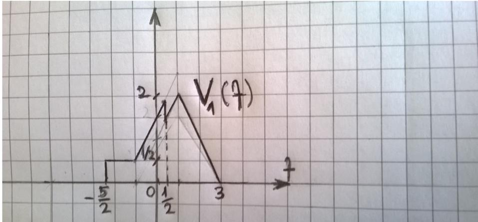
La larghezza di banda monolaterale di  $V_1(f)$  e'  $B_1 = 3$ .
