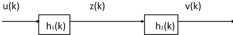
Supponendo che la risposta impulsiva del primo sistema sia  $h_1(k) = (\frac{1}{2})^k \delta_{-1}(k)$  e la risposta impulsiva del secondo sistema sia  $h_2(k) = (\frac{1}{3})^k \delta_{-1}(k)$ , si determini:
